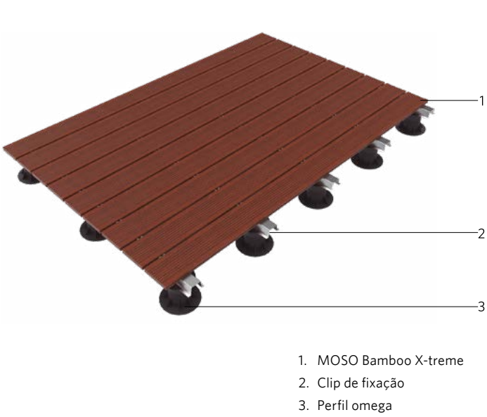
ISOMÉTRICA DO SISTEMA DE DECK
