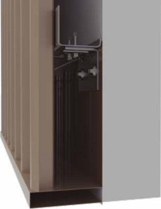
DETALHE 2: ENCONTRO SUPERIOR DA JANELA
