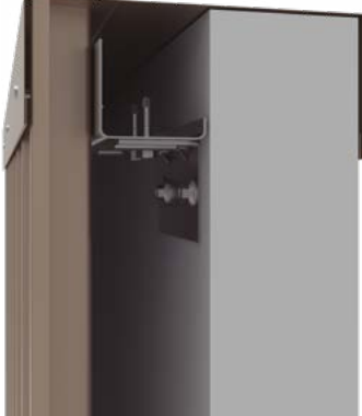
DETALHE 2: ENCONTRO SUPERIOR DA JANELA
